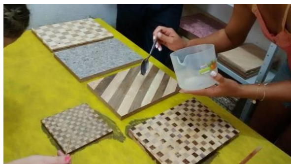
Figura 9. Aplicação de resina
